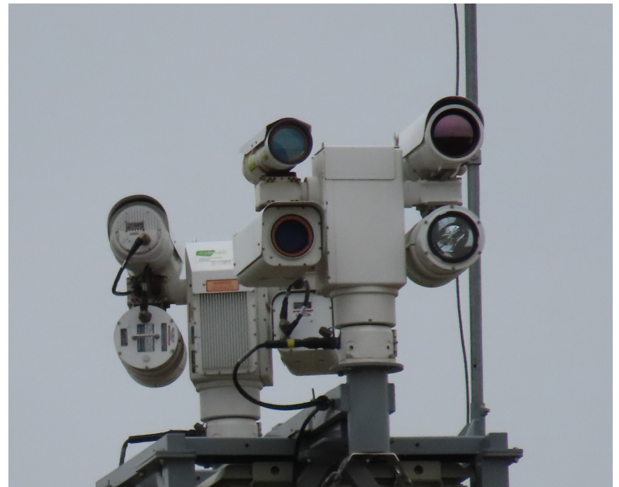
Sistemas de sensores de una R-RVSS. Fuente: EFF.
