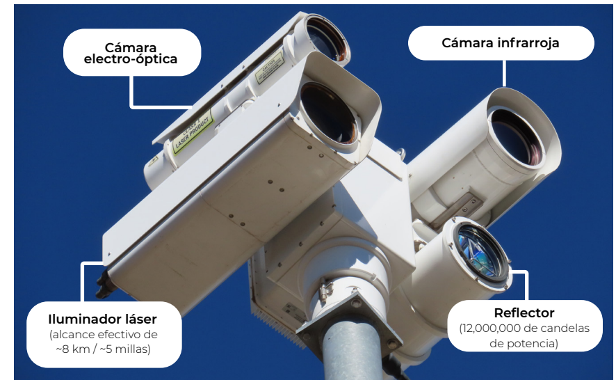
Acercamiento a los sensores de un RVSS: cámara electro-óptica, cámara infrarroja, iluminador láser (alcance efectivo de aproximadamente 8 km / 5 millas) y reflector (12,000,000 de candelas de potencia). Fuente: EFF.
