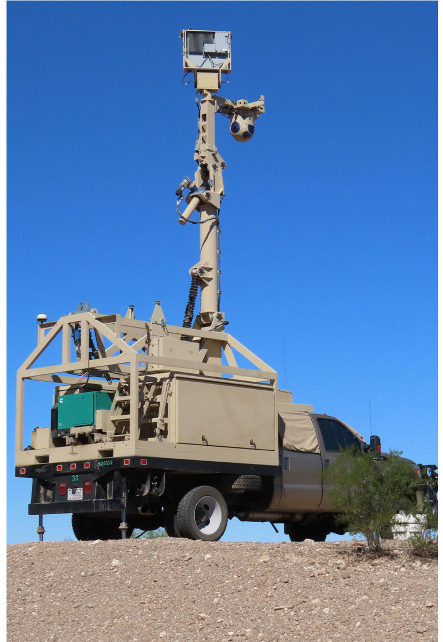
Un vehículo con Capacidad Móvil de Vigilancia (MSC) en el condado de Pima, Arizona. Este modelo, fabricado por FLIR, a veces se conoce como Sistema Móvil de Videovigilancia (MVSS). Fuente: EFF.
